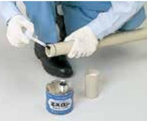
継手の内面と、管端面及び管の外面に、エスロン接着剤 (No.73Sブルー、No.75Sブルー-N、No.73S、No.75S、No.73S UV) を均一に塗布してください。
